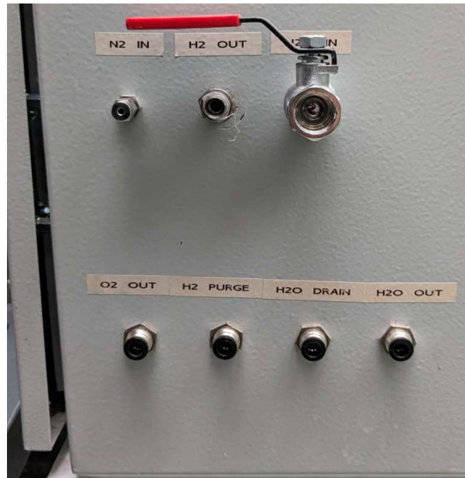
Ilustración 22: conexiones de entrada y salida del equipo
