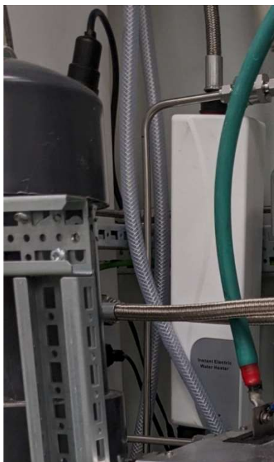
Ilustración 18: elemento calentador eléctrico del agua de trabajo
