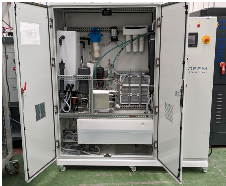
Ilustración 1: electrolizador LPGREEM
