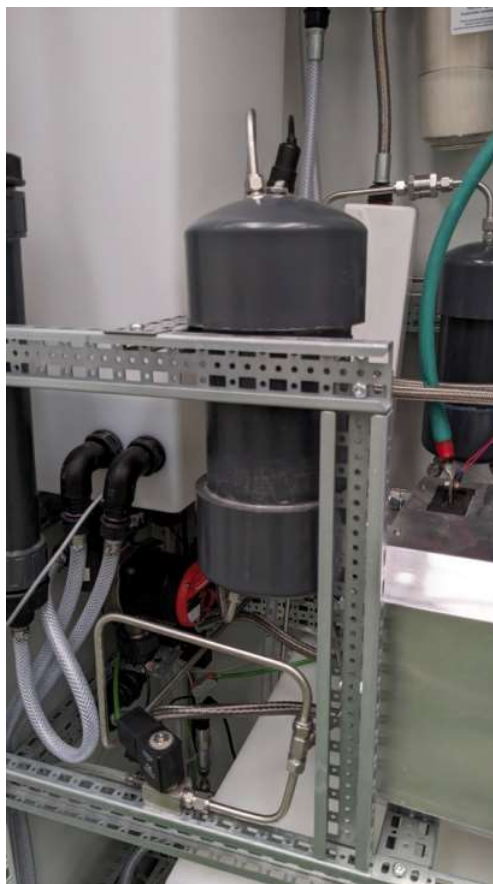
Ilustración 20: Columna 1 secado de hidrógeno
